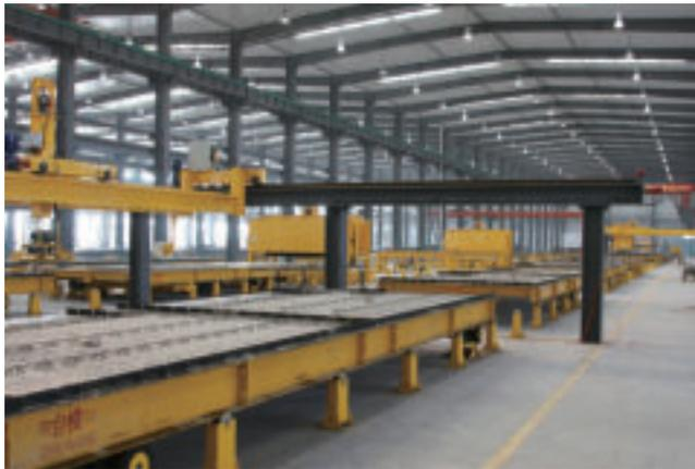
中南混凝土预制件加工基地生产线
